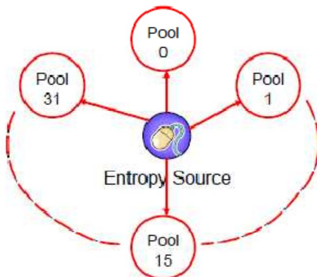
Il generatore riceve un nuovo seme ogni volta che il pool  $P_0$  è sufficientemente lungo. A seconda della variazione numero  $r$ , in esso saranno inclusi uno o più pool: la regola vuole che il pool  $P_i$  sia incluso se  $2^i$  è un divisore di  $r$ . In questo modo  $P_0$  è utilizzato in ogni variazione,  $P_1$  ogni due,  $P_2$  ogni quattro, ..
