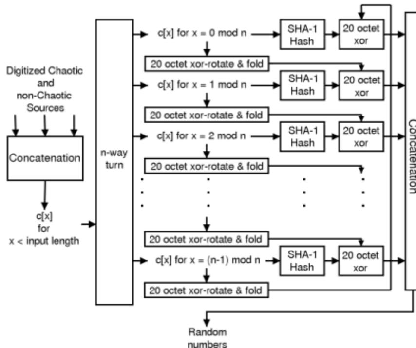
C'è un "n-way turn",  $n$  diverse SHA-1 operazioni hash in parallelo e  $n$  operazioni di xor-rotate.
