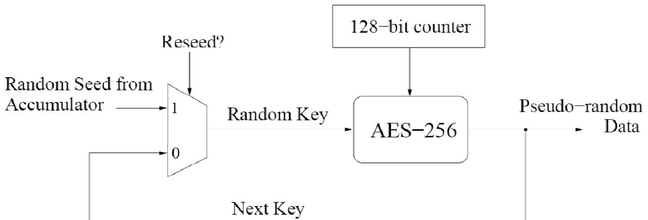
Lo stato interno del generatore è caratterizzato da una chiave di 256 bit e da un contatore di 128 bit.
